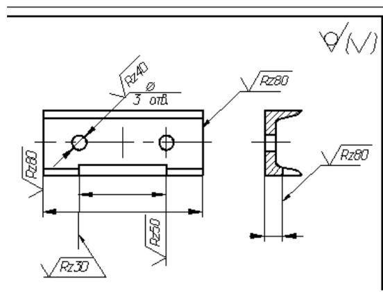
Рисунок 137б - Указание шероховатости, когда большая часть поверхностей не обрабатывается по данному чертежу
