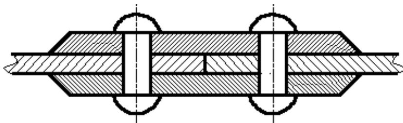
Рисунок 56 - Образец штриховки смежных площадей
