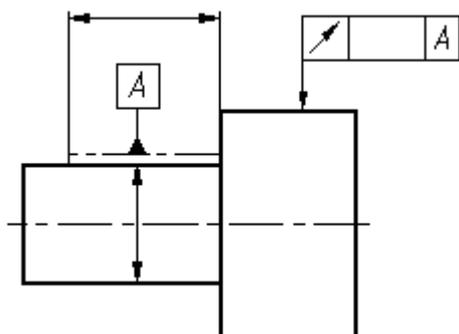
Рисунок 117 - Пример обозначения базы - определенной части элемента
