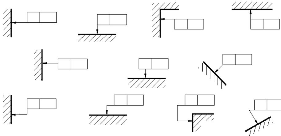
Рисунок 97 - Расположение соединительной линии по отношению к рамке
