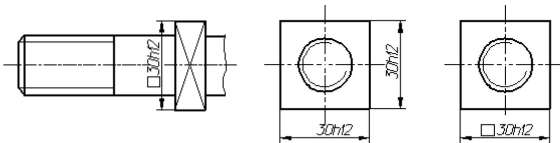
Рисунок 88 - Пример нанесение размера квадрата
