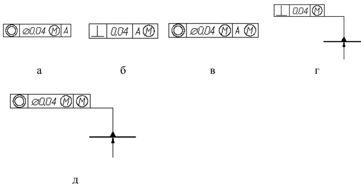
Рисунок 125 - Примеры обозначения зависимых допусков
