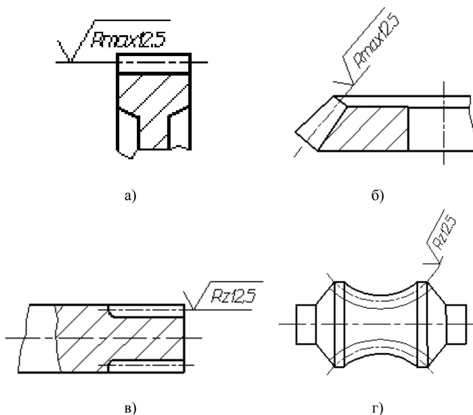
Рисунок 140 - Примеры обозначения шероховатости рабочих поверхностей зубьев
