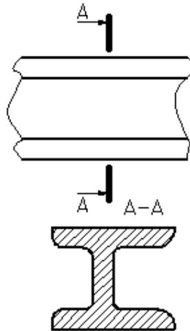
Рисунок 21 - Оформление вынесенного сечения
