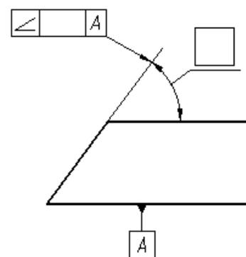
Рисунок 124 - Пример обозначения линейных и угловых размеров, ограничиваемых допуском
