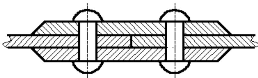
Рисунок 57 - Образец штриховки смежных площадей
