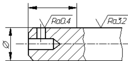
Рисунок 139 - Пример обозначения различной шероховатости на одной поверхности
