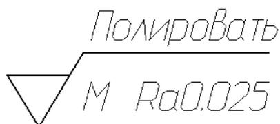
Рисунок 130 - Пример указания вида обработки поверхности
