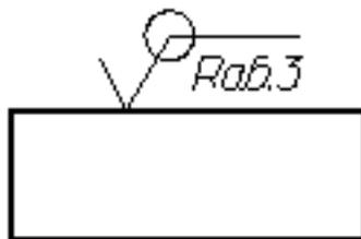
Рисунок 144 - Обозначение одинаковой шероховатости поверхностей образующих замкнутый контур
