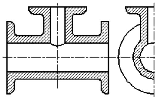
Рисунок 32 - Образец оформления линий пересечения поверхностей
