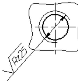
Рисунок 143 - Пример обозначения шероховатости внутренней резьбы
