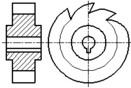
Рисунок 29 - Образец изображения равномерно расположенных элементов
