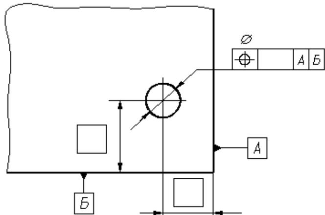
Рисунок 123 - Пример обозначения допуска расположения относительно комплекта баз
