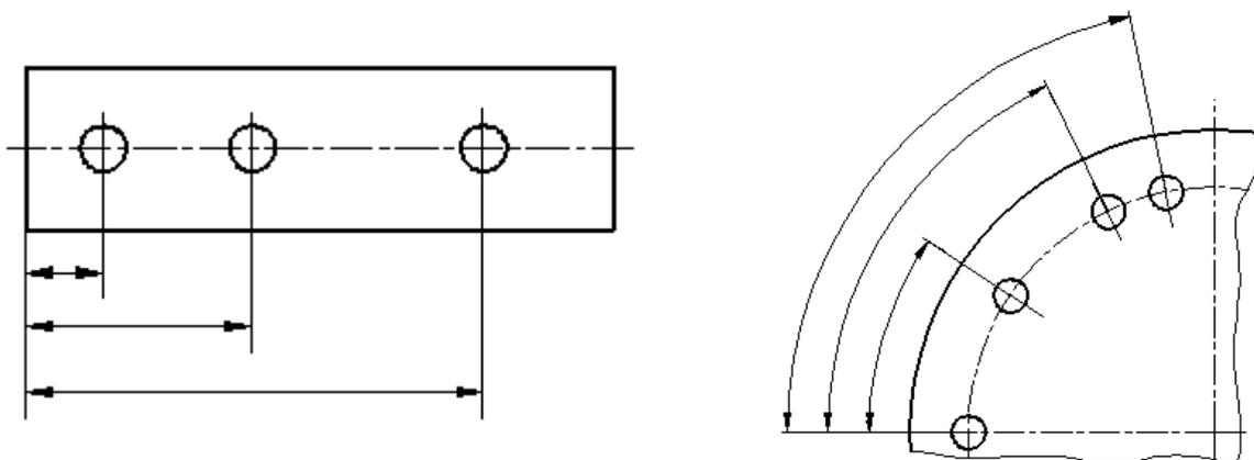
Рисунок 59 - Простановка размеров определяющих взаимное расположение окружностей от общей базы
