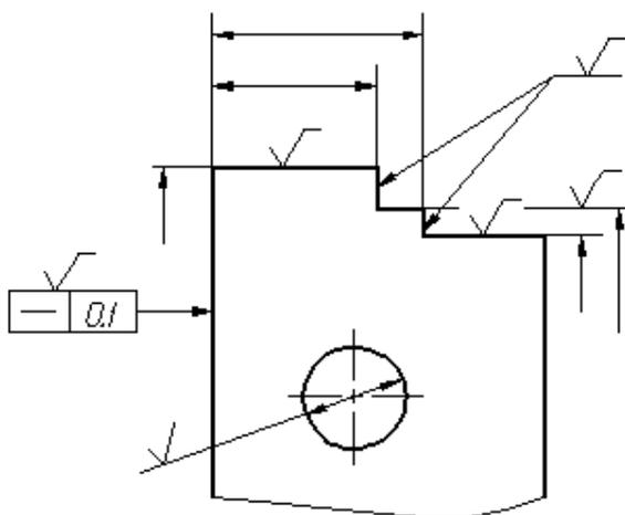
Рисунок 132 - Примеры расположения обозначения шероховатости
