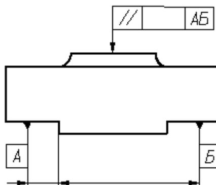
Рисунок 118 - Пример обозначения базы определенного места элемента
