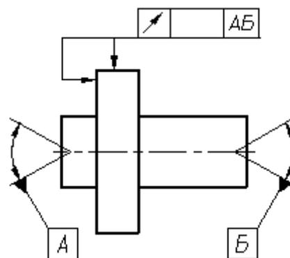
Рисунок 116 - Допущения в обозначении базовой оси центровых отверстий
