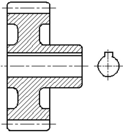
Рисунок 47 - Образец изображения отверстия в ступице зубчатого колеса
