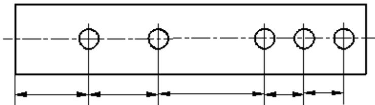
Рисунок 61 - Задание размеров между смежными элементами (цепочкой)
