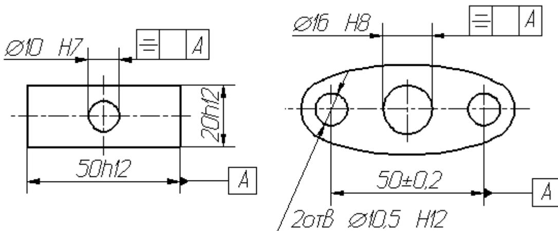
Рисунок 62 - Пример простановки размеров, определяющих положение симметрично расположенных поверхностей у симметричных изделий
