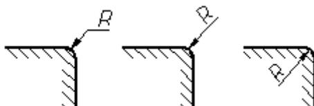
Рисунок 85 - Нанесение размеров наружных скруглений
