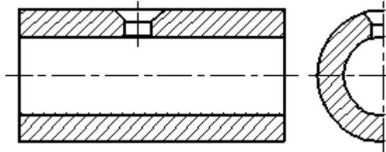
Рисунок 38 - Образец оформления плавного перехода от одной поверхности к другой
