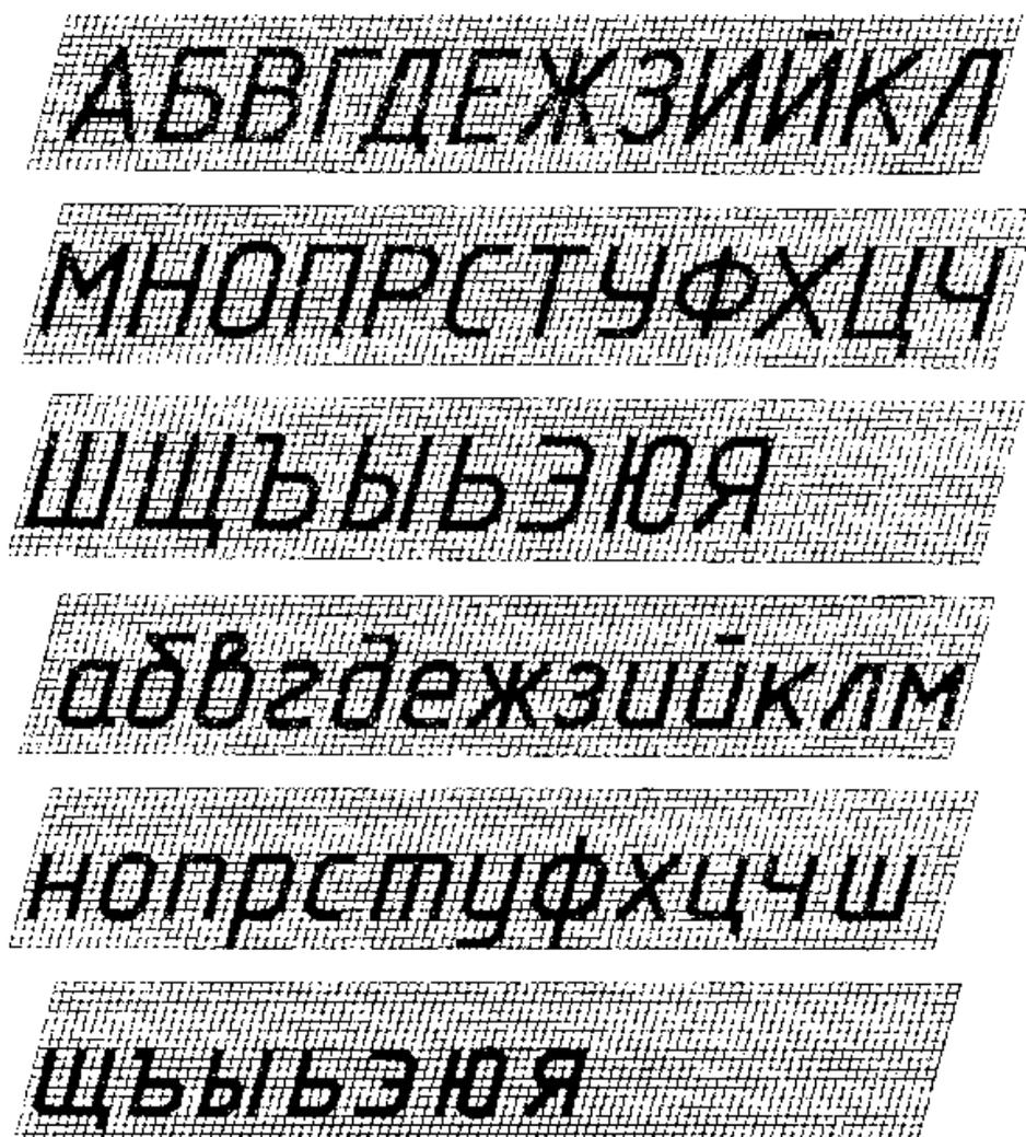
Рисунок 3 - Шрифт тип Б с наклоном
