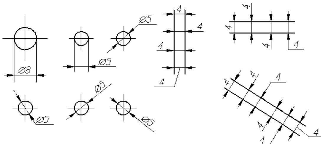
Рисунок 79 - Примеры нанесения размерных чисел
