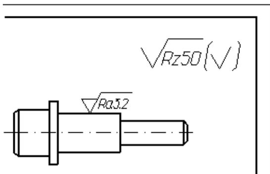
Рисунок 137а - Указание шероховатости одинаковой для части поверхностей изделия
