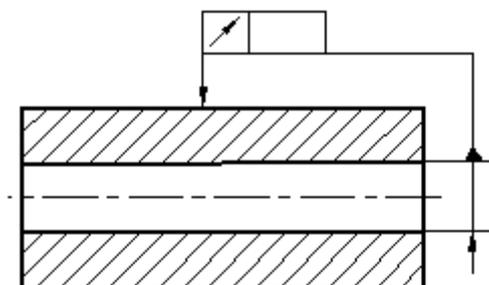
Рисунок 113 - Пример обозначения базы, когда стрелку размерной линии заменяют треугольником
