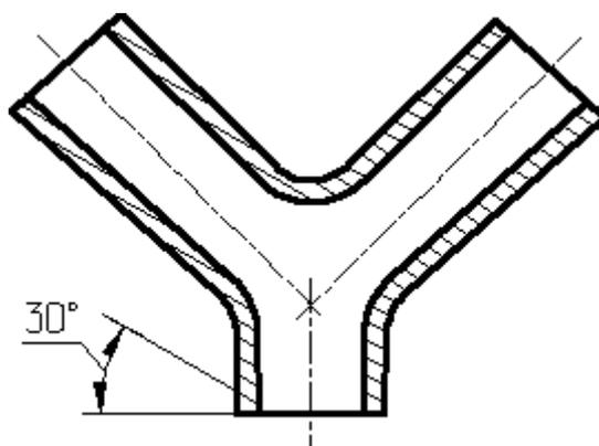
Рисунок 52 - Штриховка под углом  $30^{\circ}$  к рамке чертежа
