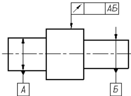
Рисунок 122 - Пример обозначения допуска расположения с объединенной базой
