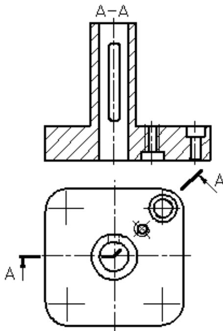
Рисунок 15 - Построение ломаного разреза
