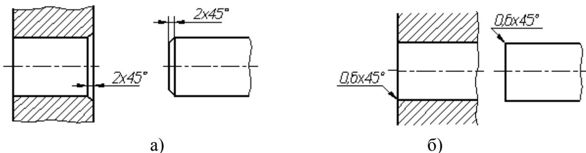
Рисунок 91 - Нанесение размера фасок под углом  $45^\circ$
