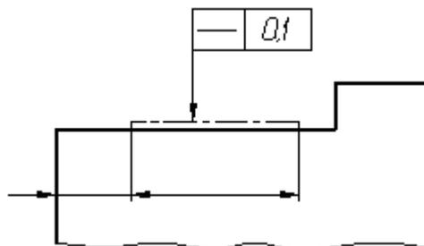
Рисунок 107 - Пример обозначения допуска, относящегося к участку, расположенному в определенном месте элемента
