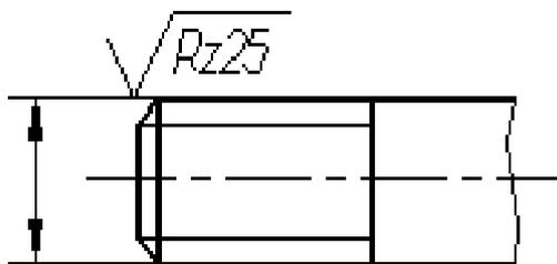
Рисунок 141 - Пример обозначения шероховатости наружной резьбы
