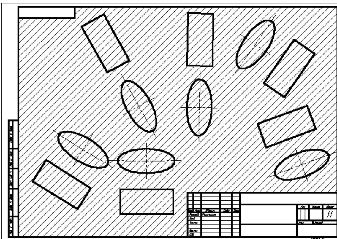
Рисунок 51 - Штриховка под углом  $45^\circ$  к рамке чертежа
