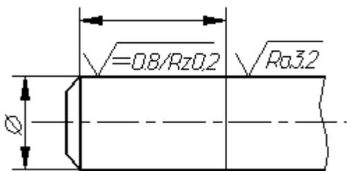
Рисунок 138 - Пример обозначения различной шероховатости на одной поверхности
