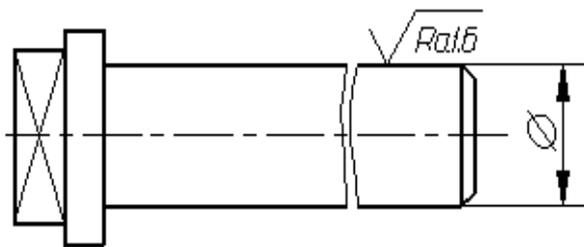
Рисунок 135 - Пример обозначения шероховатости поверхности
