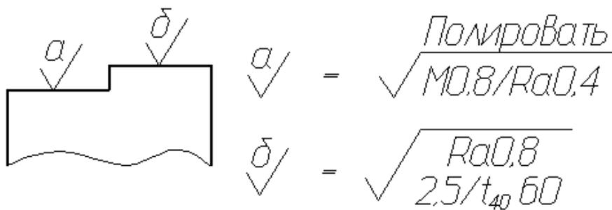
Рисунок 131 - Пример упрощенного обозначения шероховатости
