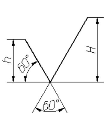
Рисунок 127 - Обозначение шероховатости поверхности без указания способа обработки
