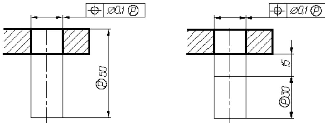
Рисунок 108 - Пример обозначения выступающего поля допуска
