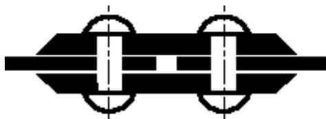
Рисунок 55 - Штриховка узких площадей ширина которых на чертеже менее 2 мм.
