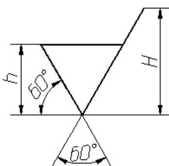
Рисунок 128 - Обозначение шероховатости поверхности при образовании которой обязательно удаление слоя материала
