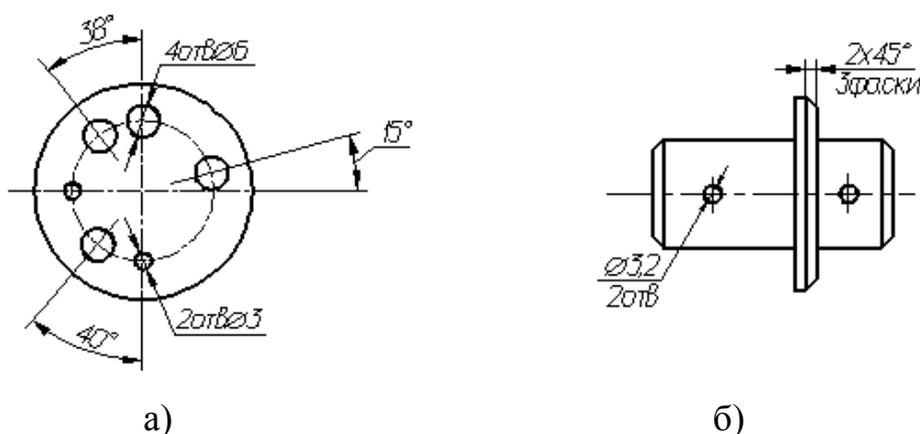
Рисунок 93 - Пример нанесения размеров нескольких одинаковых элементов
