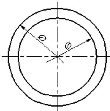
Рисунок 76 - Пример нанесение диаметра окружности
