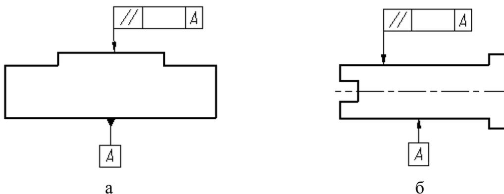
Рисунок 120 - Пример использование третьей графы рамки для обозначения поверхности, к которой относится отклонение расположения
