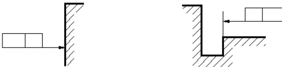
а) проводить соединительную линию от последней части рамки
