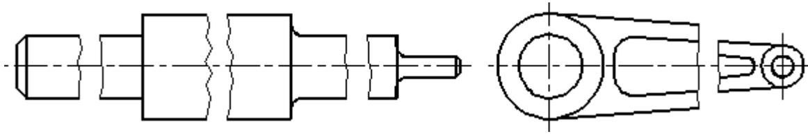
Рисунок 43 - Образцы изображения предметов, имеющих постоянное или закономерно изменяющиеся сечение
