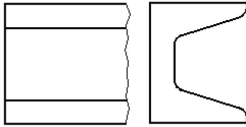
Рисунок 40 - Образец изображения незначительных уклонов
