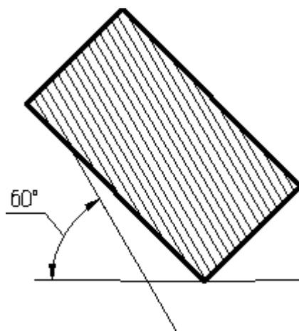
Рисунок 53 - Штриховка под углом  $60^{\circ}$  к рамке чертежа
