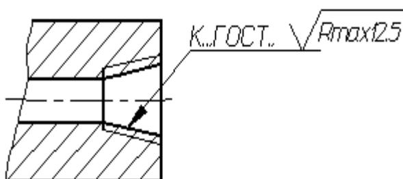
Рисунок 142 - Пример обозначения шероховатости внутренней конической резьбы
