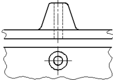
Рисунок 41 - Образец изображения незначительной конусности
