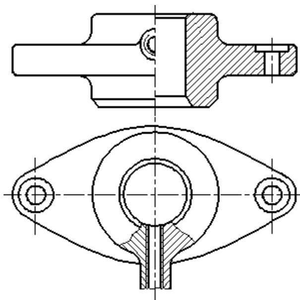
Рисунок 19 - Совмещение на изображении части вида и разреза
