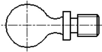
Рисунок 37 - Образец оформления плавного перехода от одной поверхности к другой
