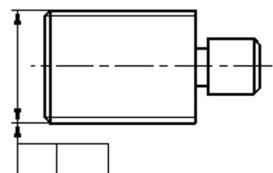
б) допуск относится к оси
