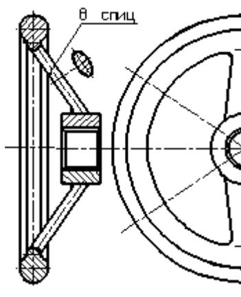
Рисунок 30 - Образец изображения равномерно расположенных элементов
