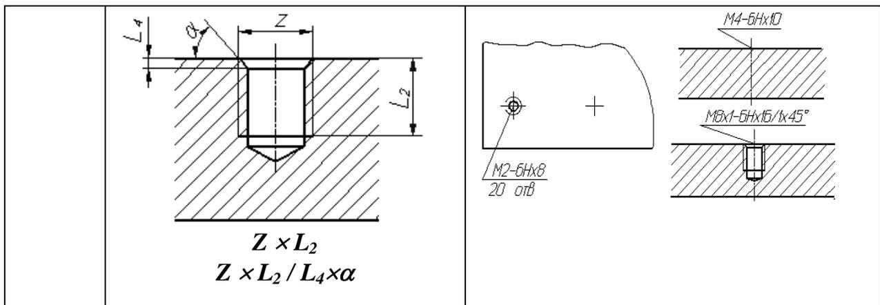
Обозначения элементов отверстий, используемые в структуре записей для различных типов отверстий:
