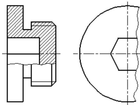
Рисунок 18 - Совмещение на изображении части вида и разреза
