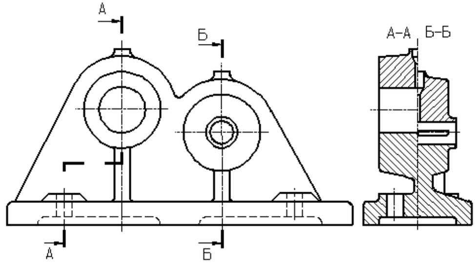
Рисунок 48 - Пример совмещения разрезов
