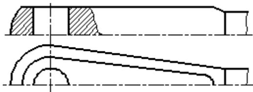
Рисунок 33. - Образец оформления линий пересечения поверхностей
