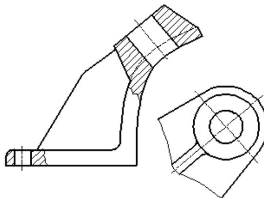
Рисунок 10 - Дополнительный вид построенный без нарушения проекционной связи
