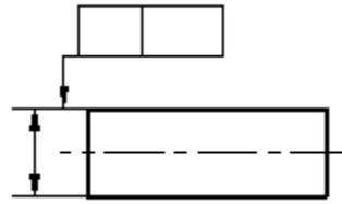
Рисунок 100 - Соединение рамки с продолжением контурной линии
