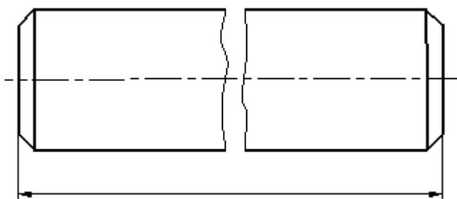
Рисунок 77 - Нанесение размера при изображении изделия с разрывом
