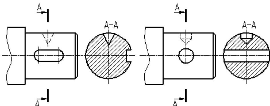
Рисунок 27 - Оформление сечения, проходящего через ось поверхности вращения
