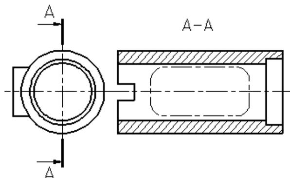
Рисунок 45 - Изображение части предмета, находящейся между наблюдателем и секущей плоскостью
