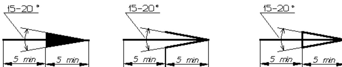
Рисунок 11 - Размеры стрелок определяющих направление взгляда
