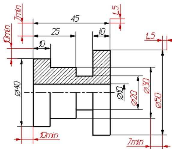
Рисунок 73 - Требования к нанесению размеров
