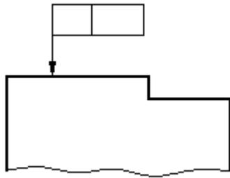
Рисунок 99 - Соединение рамки с контурной линией
