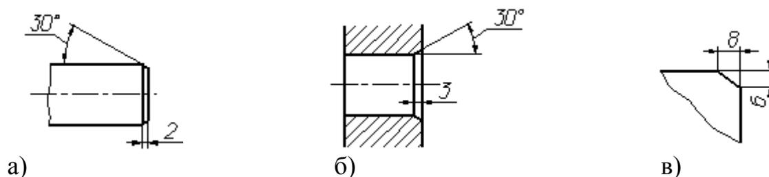
Рисунок 92 - Пример нанесение размера фаски по углом не равным  $45^\circ$
