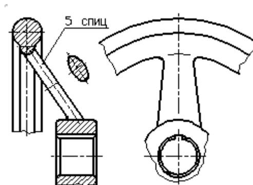
Рисунок 31 - Образец изображения равномерно расположенных элементов
