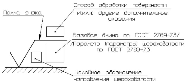
Рисунок 126 - Структура обозначения шероховатости поверхности
