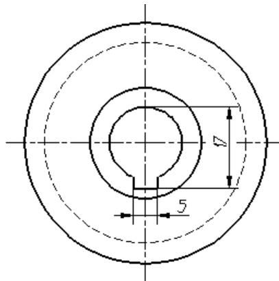
Рисунок 81 - Пример нанесения размеров
