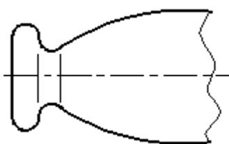
Рисунок 35 - Образец оформления плавного перехода от одной поверхности к другой
