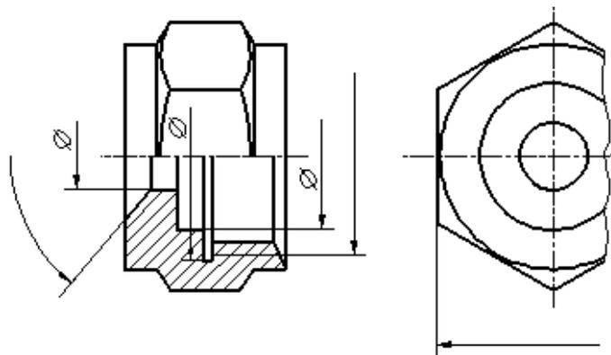
Рисунок 75 - Пример нанесения размера с обрывом размерной линии
