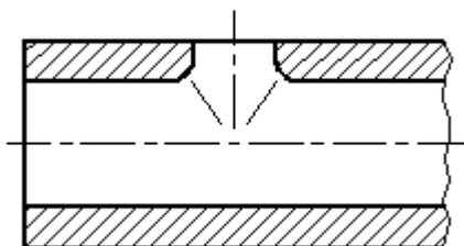
Рисунок 34 - Образец оформления плавного перехода от одной поверхности к другой
