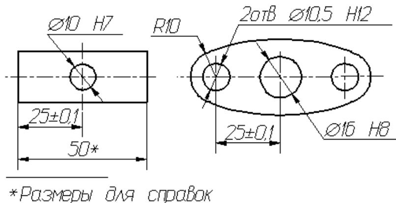
Рисунок 63 - Пример простановки размеров, определяющих положение симметрично расположенных поверхностей у симметричных изделий
