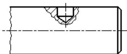
Рисунок 16 - Местный разрез, ограниченный сплошной волнистой линией
