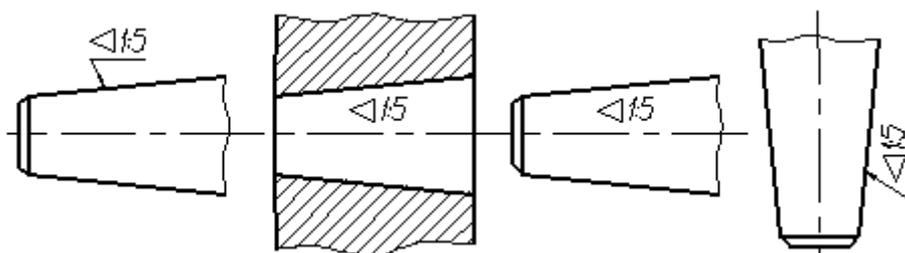
Рисунок 89 - Пример нанесение размера конусности
