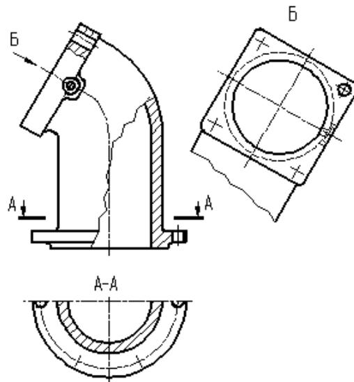
Рисунок 9 - Расположение и обозначение дополнительного вида
